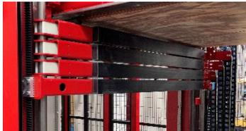
Performancestark: Mit vier Anschlägen pro Seite ermöglicht die SIMPRESS die optimale Verteilung der 3t-Druckkraft beim Verpressen von Korpusen mit bis zu 1600 mm Höhe.
