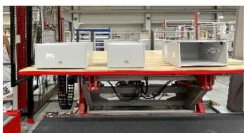
Eine weitere neue Arbeiterleichterung im Fertigungsfluss bei Palmberg: die automatische Wendestation für die Sockelmontage.
