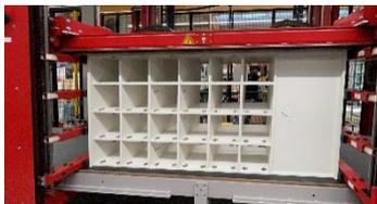
Losgröße 1? Kein Problem mit der SIMPRESS. Die Durchlauf-Korpuspresse verpresst die unterschiedlichsten Schrankvarianten mit Korpusgrößen bis 3000 mm Breite, 1600 mm Höhe und 1000 mm Tiefe problemlos - und Dank Servo-Antrieb auch noch nahezu geräuschlos.
