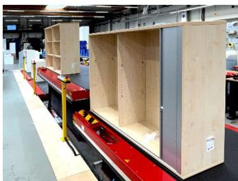
Für ein ergonomisch optimales Arbeiten in der Schrankfertigung lieferte Werges Maschinenbau für die Produktion bei Palmberg u.a. höhenverstellbare Vor- und Endmontagebänder.
