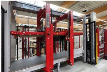
Mit der **selbstjustierenden** Durchlauf-Korpuspresse SIMPRESS Spezial von Werges Maschinenbau und up in machines hat Palmberg im Herbst 2022 seine Fertigungskapazitäten in der Schrankproduktion modernisiert. Auf der Presse werden vorwiegend Schrank-Sonderkonstruktionen gefertigt.
